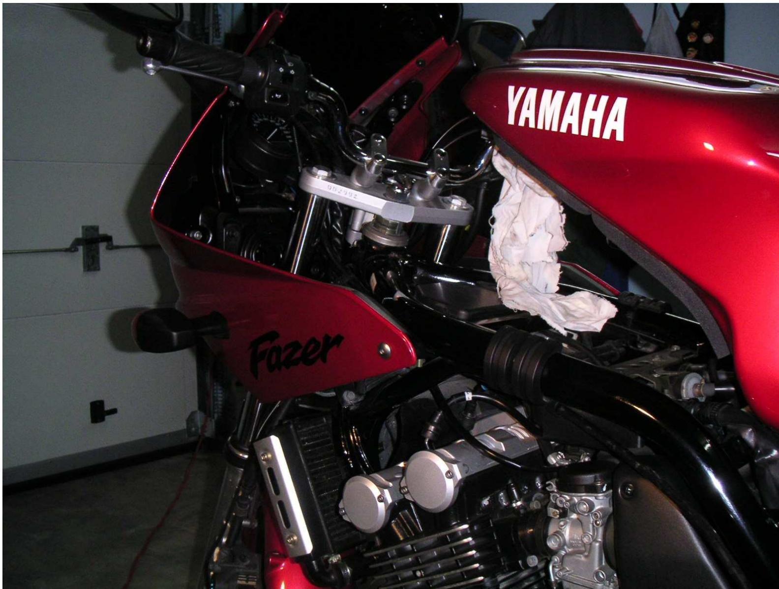
Pas la peine de le démonter complètement, il faut juste le soulever et le faire reposer sur le guidon, en protégeant le comodo par un chiffon.
