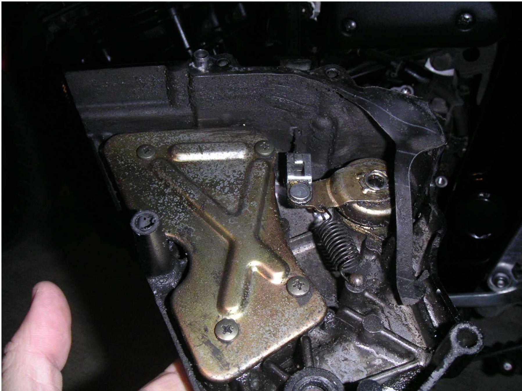
Sortir le cable du coté du levier c'est très simple; il faut le detendre et sortir la boule par la fente de la vis de réglage et du levier
