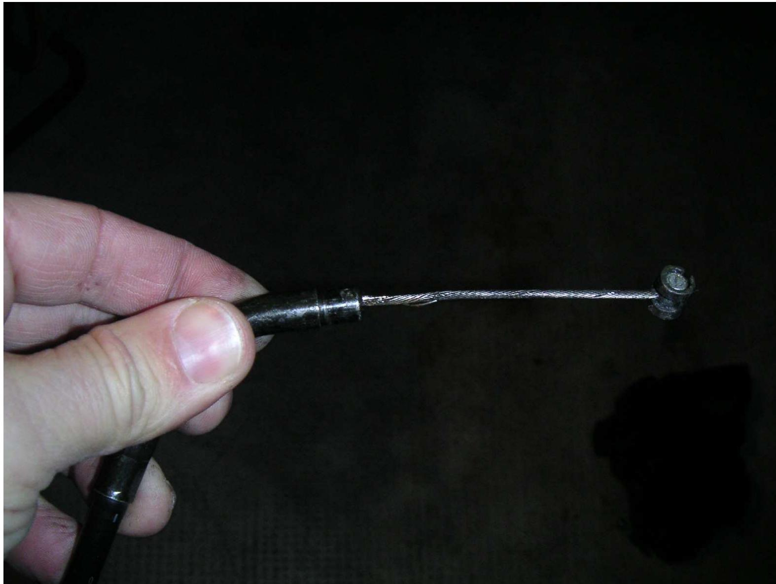
Maintenant il faut sortir le cable et sa gaine et le remplacer par le nouveau. Il faut bien repérer le cheminement du cable le long du cadre pour le pas risquer de le plier ou de le laisser trainer sur le moteur chaud.
