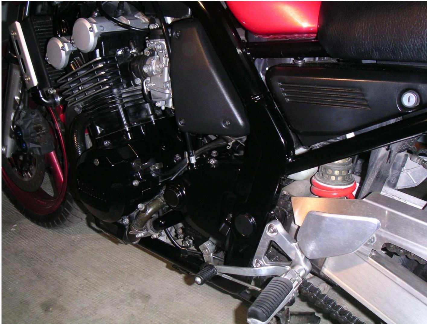
Sur cette photo on distingue bien l'arrivée du cable au niveau du cache de pignon de sortie de boîte. C'est ce cache qu'il faut démonter.
